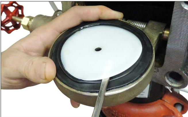
4. 從閥瓣密封內側撬開密封墊片邊緣，如上圖所示。請勿通過內孔口撬出密封墊片。
