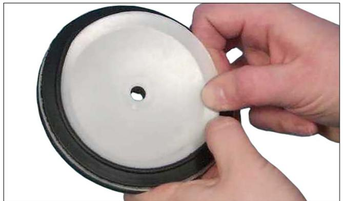
7. 小心地將密封墊片插入到密封墊圈的密封層緣下方。
