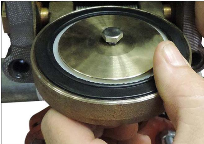
10. 將密封定位環放到閥瓣密封的密封墊片上。將密封裝配螺栓/螺栓密封裝入密封定位環和閥瓣中。
