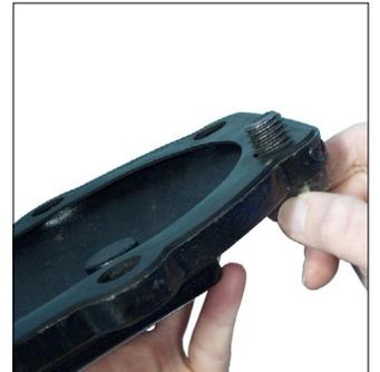
2. 將蓋板密封墊圈的孔口對準蓋板的孔口。
