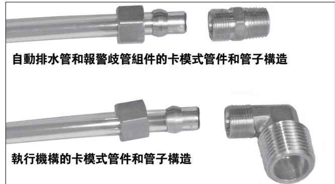
5. 提供的卡模式管件和管子用於從自動排水管的出口、報警歧管元件和執行機構連接到集水杯或排水溝。請按照提供的配管圖紙安裝卡模式管件。**嚴禁使用旋塞代替卡模式管件/管子插入自動排水管的出口、報警歧管元件或執行機構中。**
