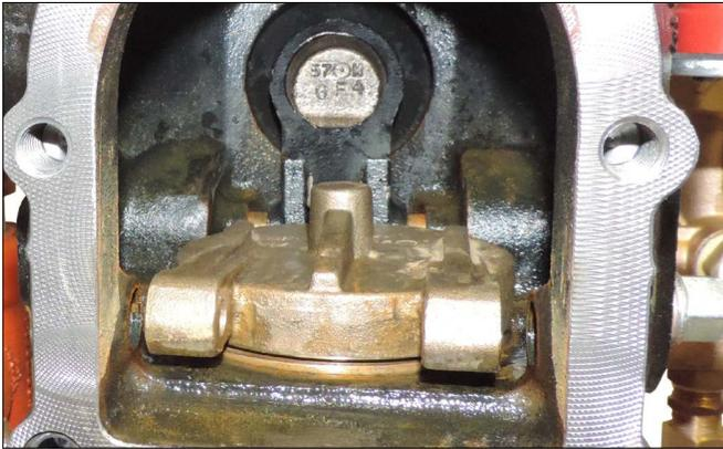
5. 將新的閥瓣組件放到閥體閥座環上。確認閥瓣臂中的孔口對準閥體中的孔口。
